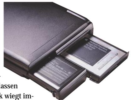
Das herausziehbare Diskettenlaufwerk (im Bild rechts) schafft Platz für zusätzliche Erweiterungen.
