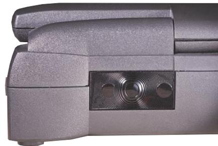
Die Infrarotschnittstelle erlaubt den kabellosen Datenaustausch über Entfernungen bis zu drei Metern.
